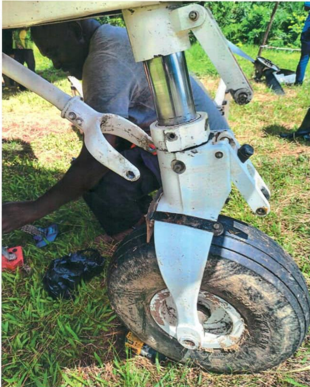
Boulons reliant la fourche sous le capot moteur au train cisailés
